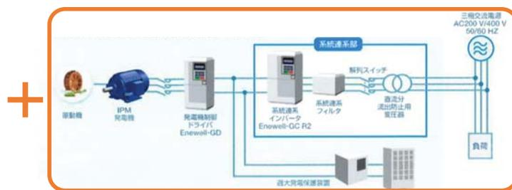
FIT売電のために、低圧配電線との連系のためのパワーコンディショナ(コンバータ・インバータ)を設置。
