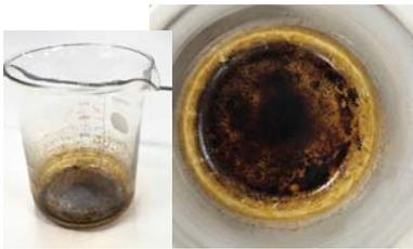
ラボスケールのガス化試験で回収したタール
