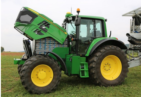
Johndeere (2020、アメリカ) 130kWモータ、130~150kWhバッテリー
