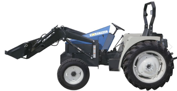
SOLETRAC (2020、アメリカ) 30kWモータ、28kWhバッテリー搭載 $ 45,000 = 485万円
