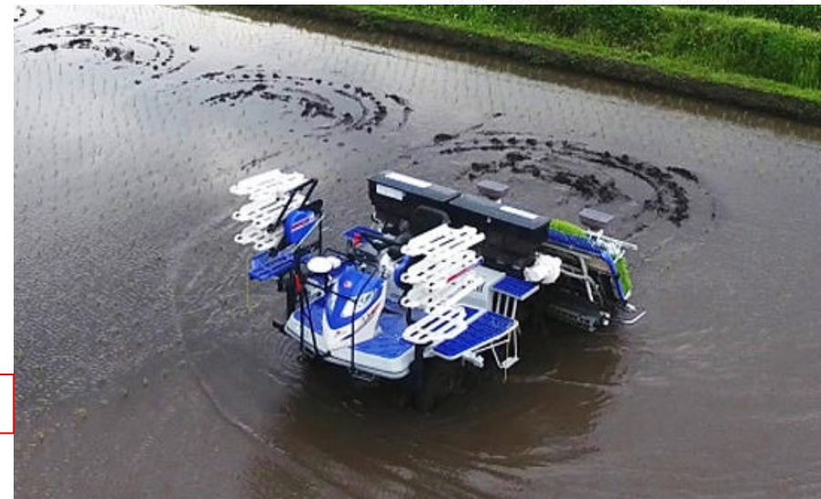
無人作業中の自動運転田植機 (自動旋回の様子) 7
