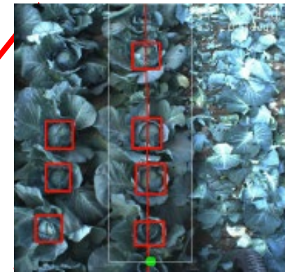
AIでキャベツを認識し、自動収穫
