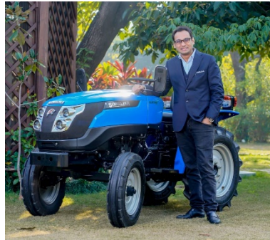
SONALIKA TRACTORS (2020、インド) 11kWモータ、25.5kWhバッテリー 5.99lakh = 86万円
