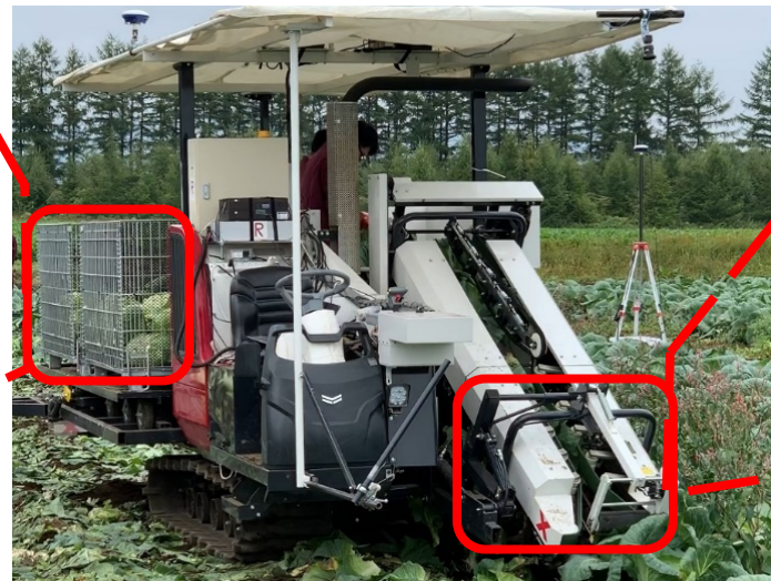
AIでキャベツを認識し、自動収穫
